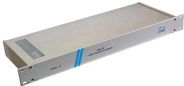
Сумматоры STA 22 выпускается в корпусе 19" высотой 1U по стандарту IEC 60297 и рассчитан на установку в шкафы и стойки 19". Корпус обеспечивает класс защиты IP51 по IEC 60529, материал корпуса — алюминиевый сплав.
